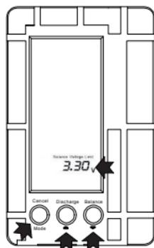
2. Taste „**Mode**“ einmal gedrückt: Einstellen der unteren Balancerspannung (Balance Voltage Limit). Die Einzelzellen-Spannung des zu balancierenden Akkus muss oberhalb dieser Spannung liegen, damit der Vorgang gestartet wird.
