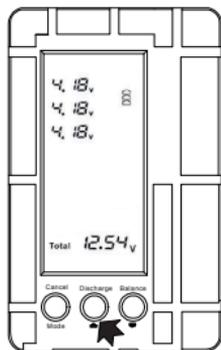
Stecken Sie den Akku an den passenden seitlichen Balanceranschluss, damit die Anzeige aktiviert wird.
