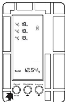
Avant la première utilisation, il faut vérifier et régler éventuellement la tension maximale de décharge et la tension du Balancer. Branchez un accu sur la prise Balancer latérale pour activer l'affichage.
