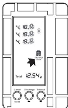
2. Der Balancer startet den Balanciervorgang, angezeigt durch das Batterie-Symbol. Das blinkende
