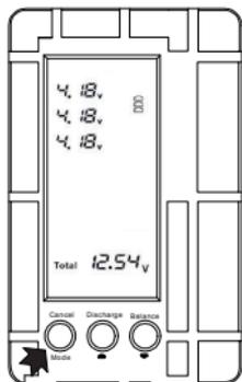
Vor der ersten Inbetriebnahme müssen die Entladeschluss- und Balancer-Spannung überprüft und gegebenenfalls eingestellt werden. Stecken Sie dazu einen Akku an einen seitlichen Balanceranschluss, damit die Anzeige aktiviert wird.
