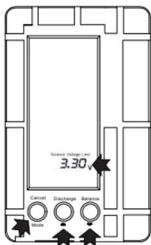
2. Une impulsion sur la touche „**Mode**“: Réglage du seuil inférieur de la tension du Balancer (Balancer Voltage Limit). La tension de chaque élément de l'accu à équilibrer doit se situer au-dessus de cette tension pour que la procédure se lance.
