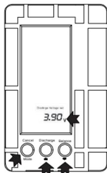
3. Taste „**Mode**“ zweimal gedrückt: Einstellen der Entladeschlussspannung (Discharge Voltage Set). *Achtung:* die optimale Lagerspannung muss an den angeschlossenen Akku angepasst werden!
