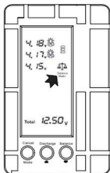
2. Der Balancer nimmt die niedrigste Zellenspannung als Referenz und startet den Balanciervorgang, angezeigt durch das Waage-Symbol. Das blinkende
